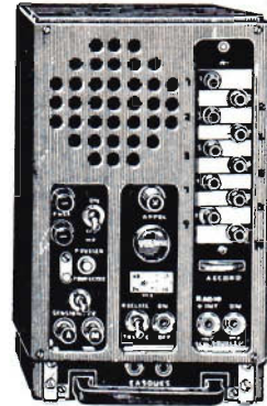
Fig. 4 - Modello di ricevitore BC603 molto diffuso in quanto permette l'ascolto della gamma CB dei 27 MHz. La ricezione è in modulazione di frequenza, ma è facile portare il rivelatore in AM. Può essere utilizzato anche come ricevitore con convertitore per i segnali FM dei satelliti meteorologici. Il costo è modesto.
