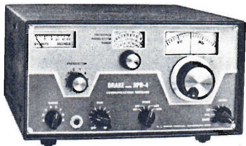
Fig. 9 - Ricevitore DRAKE per radioamatori. La banda degli OM viene coperta in settori da 500 KHz ciascuno (per esempio da 7 a 7,5 MHz). Manca quindi di copertura generale, anche se alcuni modelli vengono progettati per funzionare al di fuori delle bande amatoriali con l'aggiunta di appositi quarzi. Si tratta di un ricevitore di costo notevole, proprio perché di moderna concezione tecnologica e molto sofisticato.
