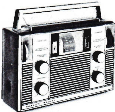
Fig. 5 - Ottimo ricevitore portatile, costruito in Sudafrica, di produzione Barlow Wadley. Copre la gamma di frequenze fra i 500 KHz e i 31 MHz in 31 bande da 1 MHz ciascuna. Permette l'ascolto di emittenti in AM-CW-SSB. Il circuito è di concezione moderna e presenta due notevoli vantaggi: la stabilità del segnale e la precisione della scala. Proprio questi due ultimi elementi lo rendono molto diffuso fra gli appassionati SWL, anche se esso risulta idoneo alla ricezione di segnali RTTY (radio teletype e telescrivente).
